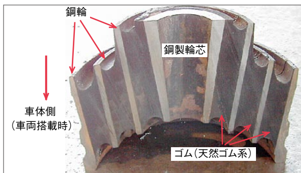
図2 軸ばねゴムの断面
