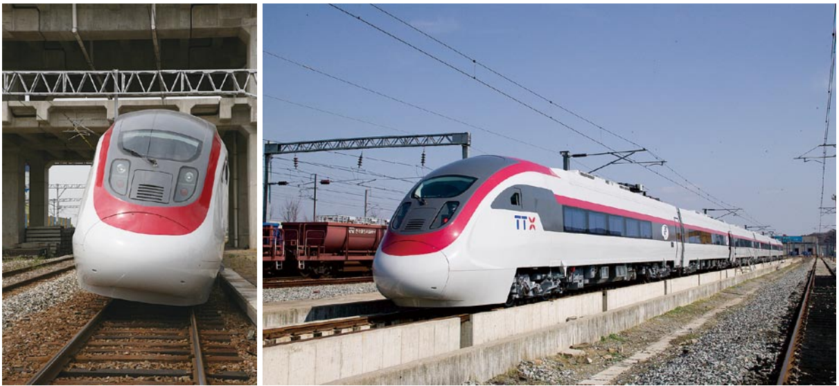
図5 新素材の車体傾斜車両
