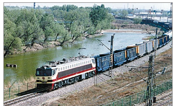
図5 ループ試験線における貨物列車の120km/hの耐久試験
