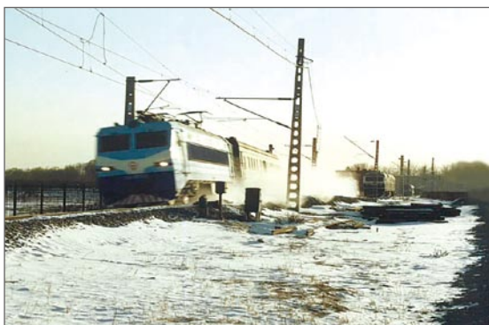
図4 ループ試験線での最高速度212.6km/hの試験
