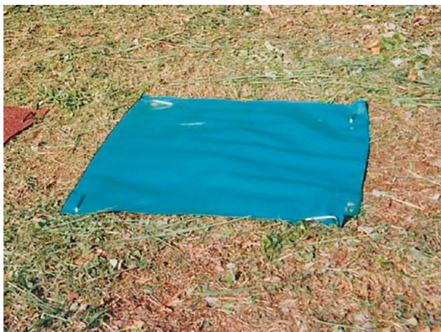
図3 防草シート試作品の試験施工状況
