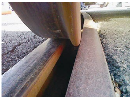
図4 路面系鉄道の内軌背面案内
