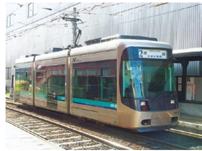
(c) 長崎電軌3000形 車軸付き 2台車3車体
