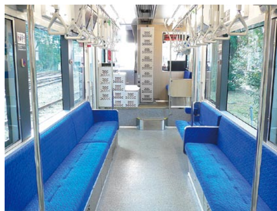
図5 超低床の車内と運転室への残バッテリー配置
