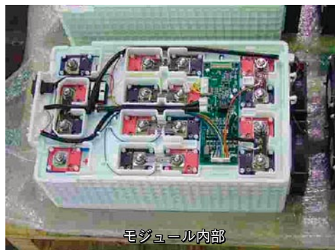
図4 リチウムイオン二次電池30Ahモジュール
