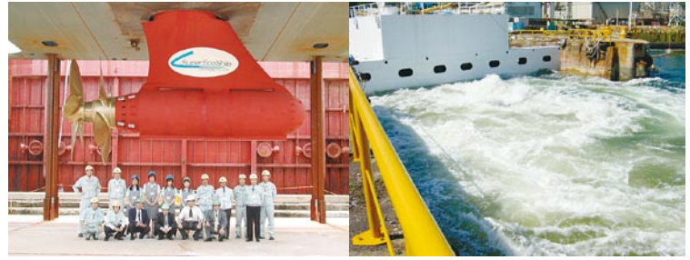
図7 開発した二重反転プロペラ型ポッド推進器の実験
