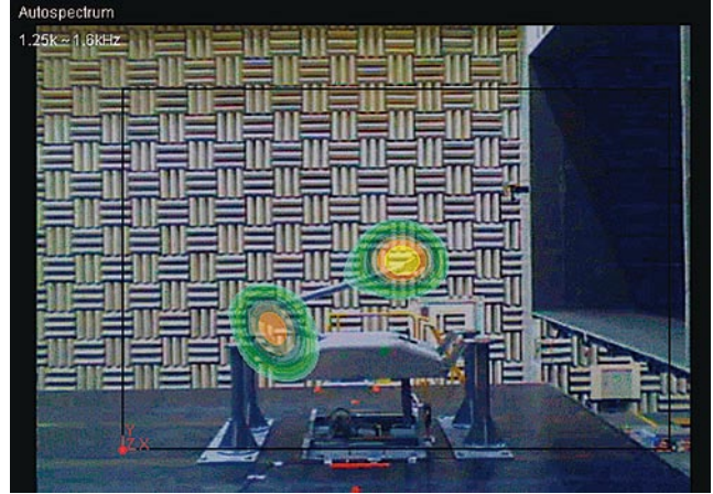
図9 パンタグラフ周りの音源分布 風速:300km/h, 周波数帯:1.25kHz~1.6kHz
