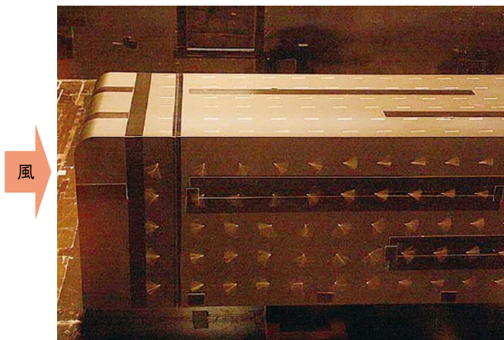
図2 1/5車両模型の表面近傍流れのタフトによる可視化 (風速50m/s, 環境工学研究部 空気力学研究室にて実施)
