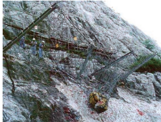
図5 試験柵を使っでの落石衝撃試験（五日市）
