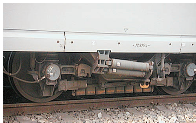
図2 直流レールブレーキを装備したドイツ新幹線・ICE3の台車
