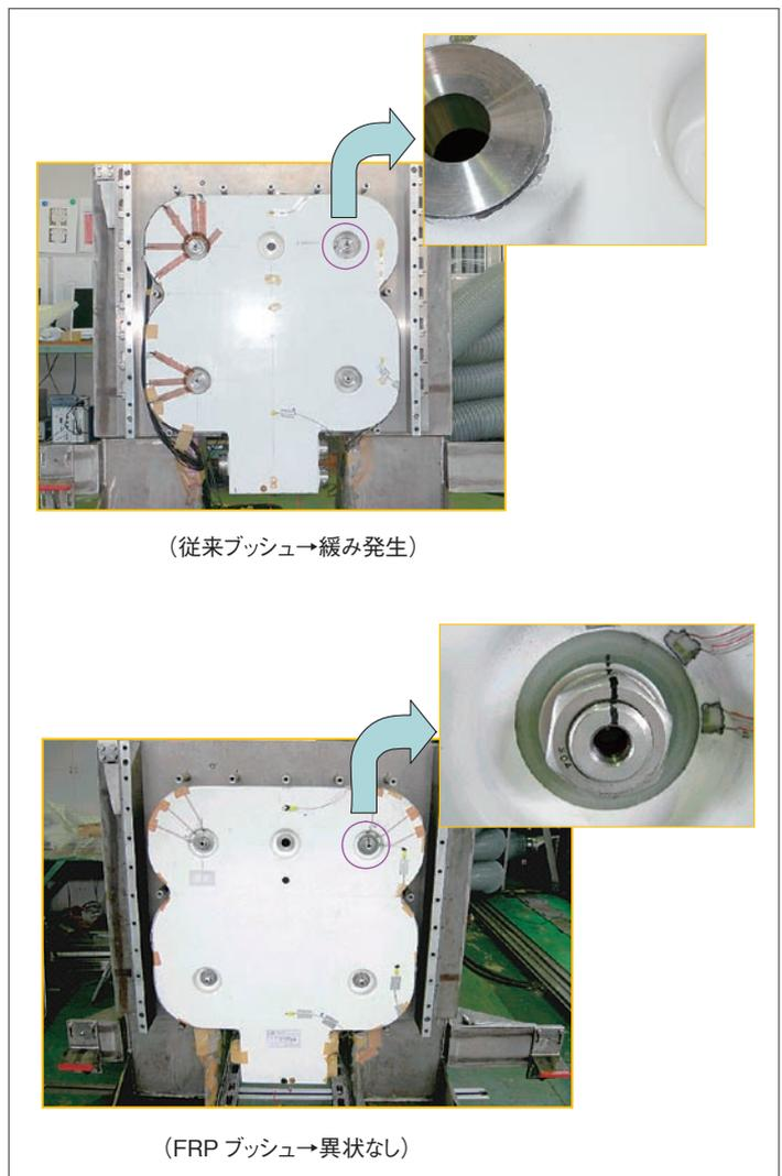
図11 地上コイル締結部の動的耐久性検証例
