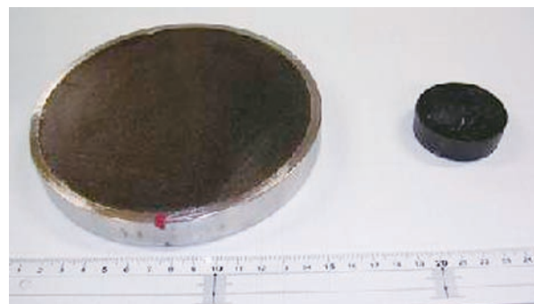
図1 大型バルク体 直径140mm 厚さ20mm(左) 従来のバルク体 直径46mm(右) (出典 ISTEC)
