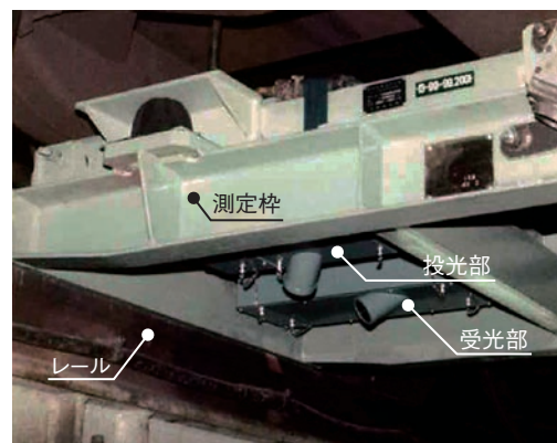
図4 撮像管方式の光学式レール変位検出装置
