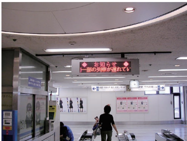
図4 駅改札口に設置されたL-Net表示器
