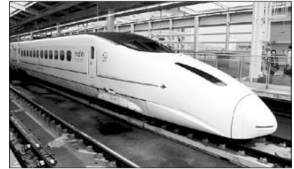
図3 微気圧波低減効果の高い列車先頭部の例
