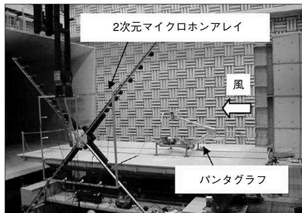
図1 鉄道総研米原風洞における風洞実験例 (パンタグラフ: 総研 PEGASUS)
