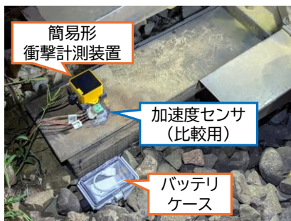
図5 簡易形衝撃計測装置と計測波形の例
