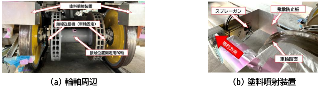
図 11 所内走行試験時の仮設状況
