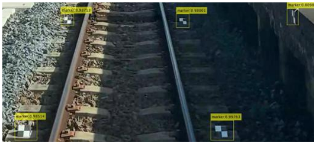
図6 YOLOv4によるマーカ検知の例
