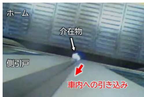
図 13 信頼性評価試験における検知状況の例
