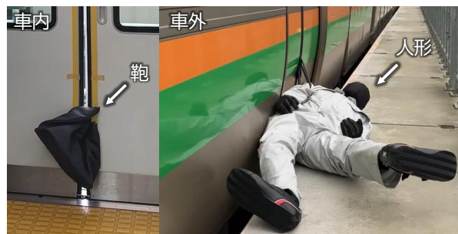
図 12 模擬引きずり試験の状況の例
