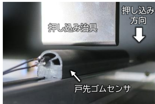
図6 熱老化試験における押し込み試験状況
