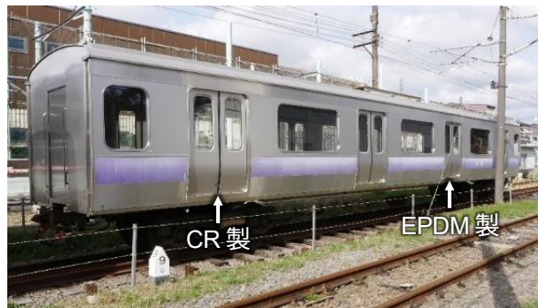
図7 屋外暴露試験における戸先ゴムセンサの設置状況
