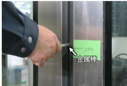
図3 挟み込み検知感度の評価状況
