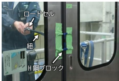
図4 引きずり検知感度の評価状況
