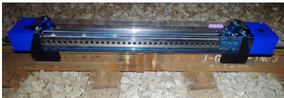
図5 レール頭頂面凹凸測定器の概要
