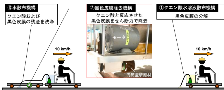
図10 黒色皮膜除去装置の概要
