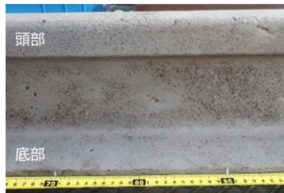
図 2 サンドブラスト処理後のレール表面
