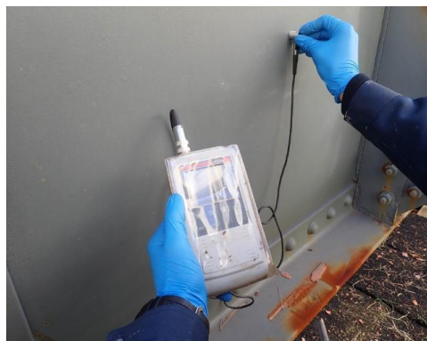
図1 電磁式膜厚計での膜厚計測例
