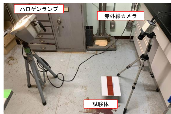
図 9 赤外線カメラの撮影状況
