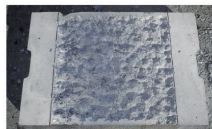
図19 凹凸の作成状況 (Case3)
