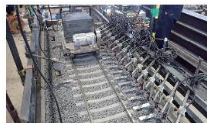
図5 小型模型の移動載荷試験状況
