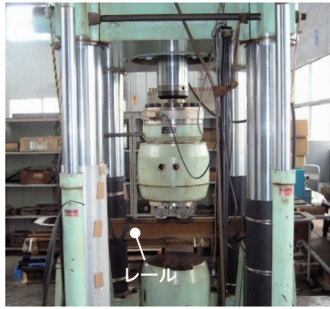
図9 曲げ疲労試験状況
