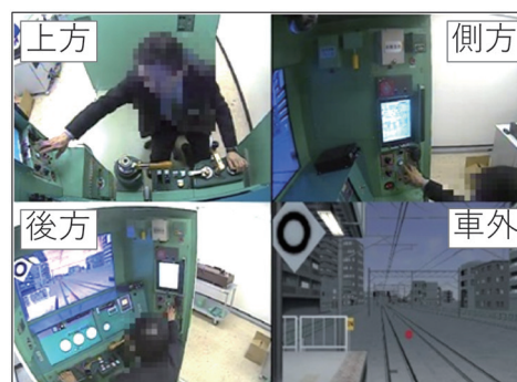
図1 振り返り支援システムの画面例 (上方，側方，後方からのカメラ映像と車外映像)
