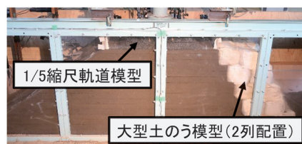
図11 応急復旧した盛土模型の外観 (case 7)
