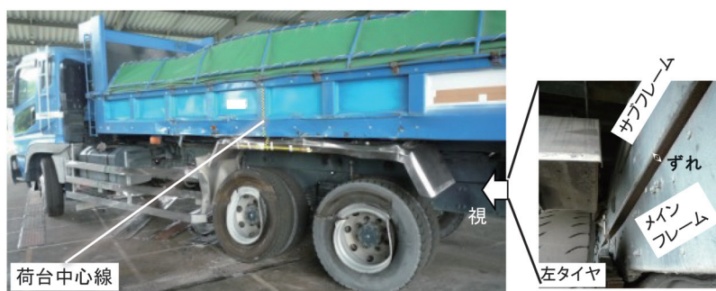
図6 ダンプトラックの変形状況
