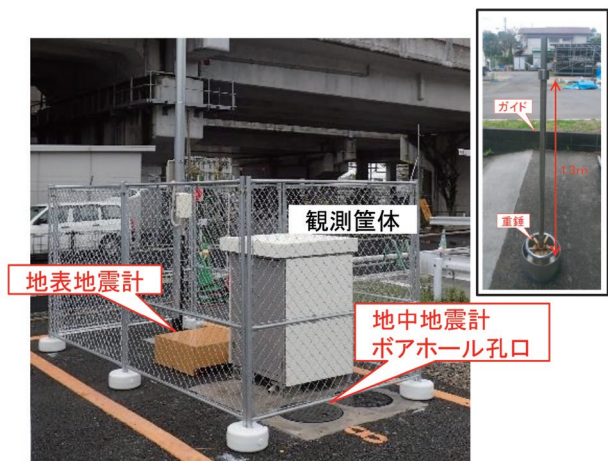
図3 観測点 KM04 の外観(左)と重錘落下装置(右)
