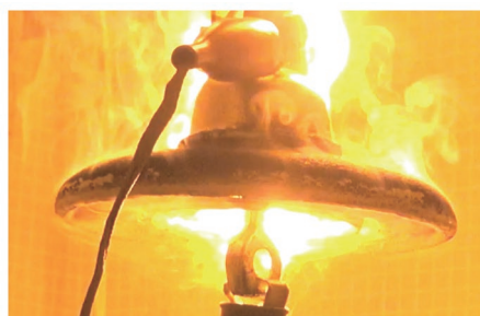
(a) がいし B (付着密度 1.2kg/m 2 ; 食塩水)
