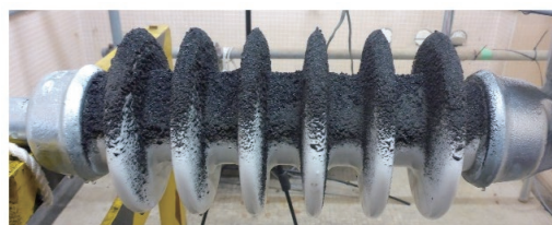
図9 長幹がいしへの火山灰の付着状況の例 3)
