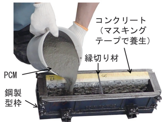
図6 PCMの打込み状況
