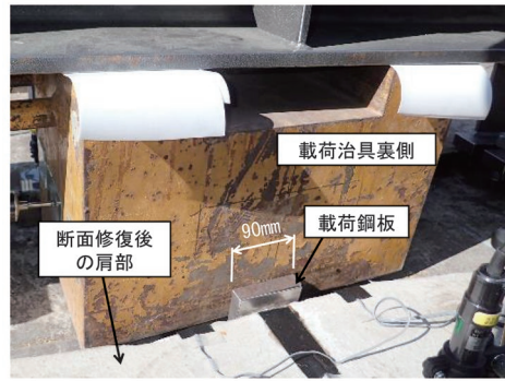
図 16 载荷鋼板の挿入状況
