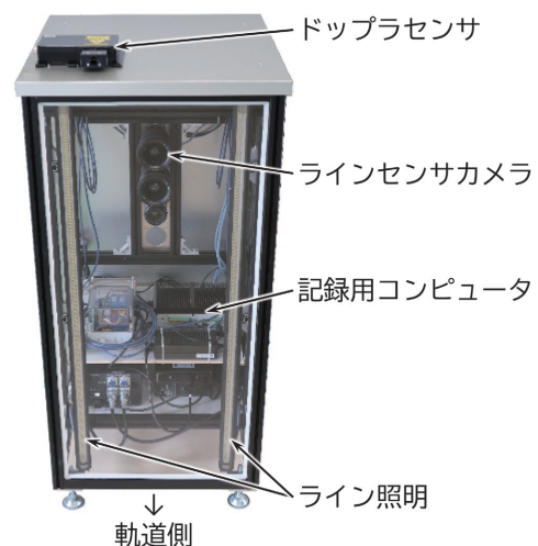
図4 試作した車両床下撮影装置
