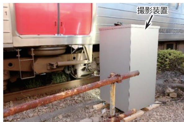
図5 試作した撮影装置による撮影試験
