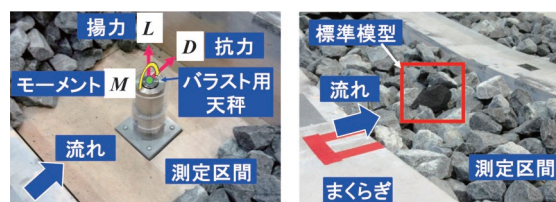
図7 バラストの空気力測定時の風景
