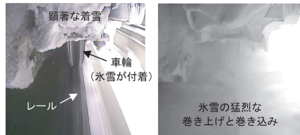
図 18 レール/車輪間の映像例（220km/h 時）
