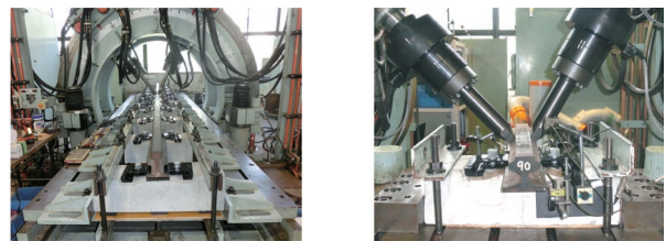
(a) 試験軌道に対する載荷試験による方法 (b) レール締結装置 1 組に対する載荷試験による方法
