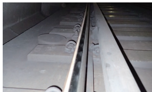
図1 レール波状摩耗の発生状況の例
