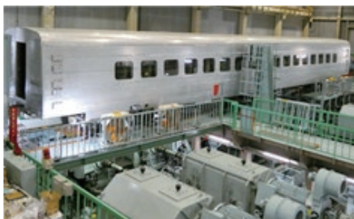
図 11 新幹線型試験車両による車両試験台試験
