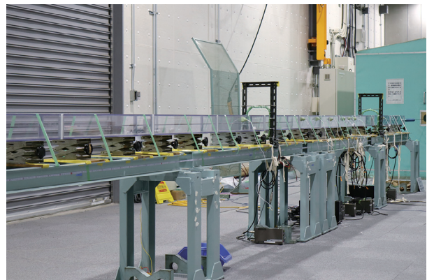
図6 スノーシェルターに関する模型実験
