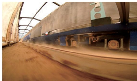
図3 模擬雪による車両模型走行実験
