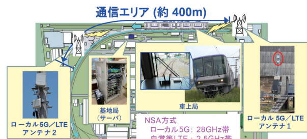
図3 ローカル5Gの設置状況
