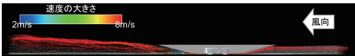
図14 鉄道車両モデルの着雪解析（側面全体）
