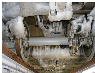
図1 着雪した鉄道車両の台車部
