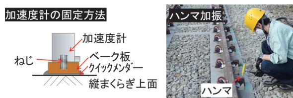
図5 インパルスハンマ試験の概要
