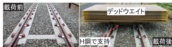
図4 静的載荷試験の概要
