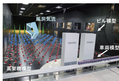
図2 風洞試験の様子
