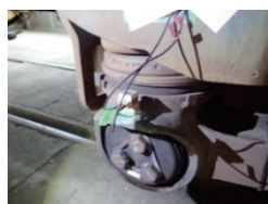
図6 軸箱支持装置と加速度計
