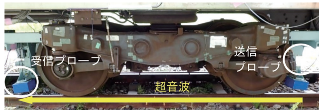
図 13 空中超音波システムを装着した台車の外観
