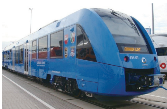
図6 ALSTOMの燃料電池鉄道車両 iLintの外観
