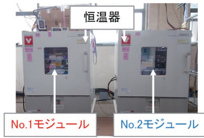
図2 駆動用電池の試験実施状況
