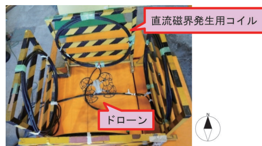
図1 磁界ばく露試験の様子
