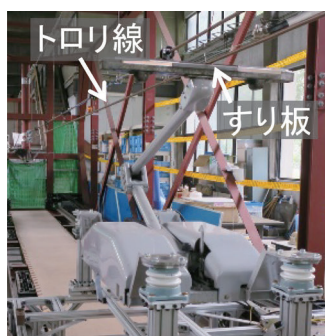
図3 低速時に発生するトロリ線摩耗への影響を調べるための実験
