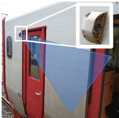
図3 車両側面カメラの設置状況の例
